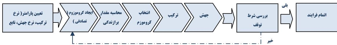
شکل ۲: ساختار الگوریتم ژنتیک (بابکلو و فیندیک<sup>۱۹</sup>، ۲۰۱۰)
